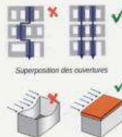
Limitation des déformations : effet «boîte»
