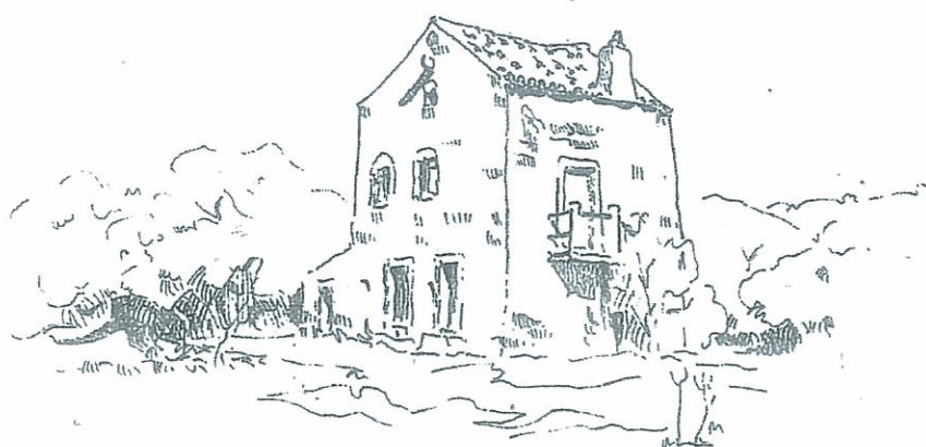
Toit à deux versants - faîtage parallèle à la façade principale - Sartène
