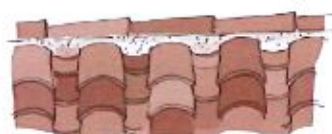
▲ faitage de tuiles scellées au mortier
