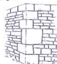
^ Principe de chaînage d'angle
