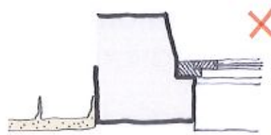
^ Enduit en surépaisseur par rapport à la pierre de taille
