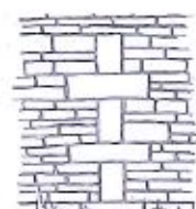
^ Principe d'harpage
